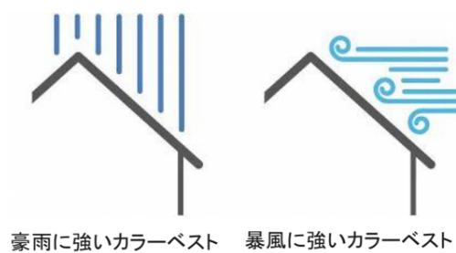
防水に配慮した設計。屋根材の重なりと下葺材で高い防水性を確保。4点をしっかり釘留めして強風での飛散を防止。
